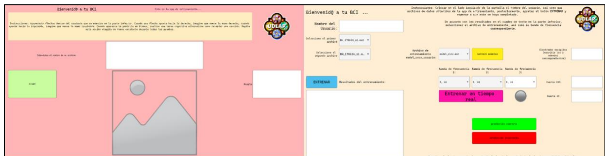
Figura 2: (a) Interfaz 1: Adquisición de las señales de EEG, (b) Interfaz 2: pre-procesamiento de la señal, extracción de características, selección de canales, frecuencias y kernel, exportación de modelos y pruebas on-line.
