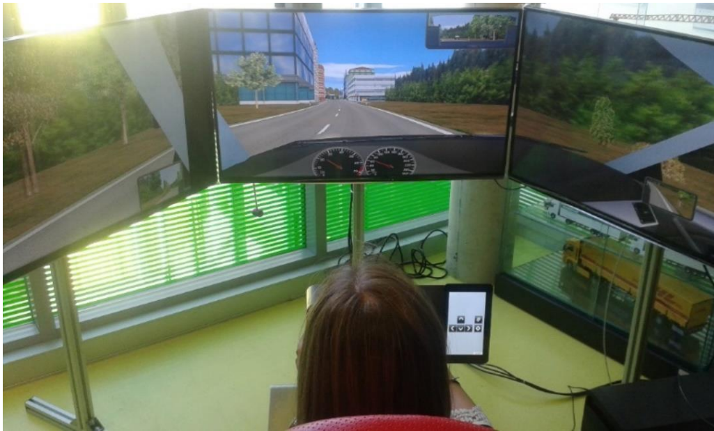
Fig.1: Experimento con simulador de manejo (Simu Tech GmbH, Bremen, 2017) de un vehículo tradicional: transmisión automática, triple pantalla, velocidad máxima 220 km/h, tres espejos retrovisores, indicadores de laterales, pedales y volante incluidos.
